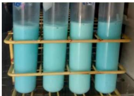
Figura 8: Prueba de reducción de azul de metileno.
